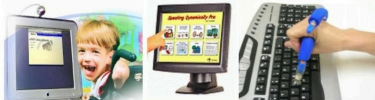
Teclado IntelliKeys, acionadores com mouse adaptado, mouse por movimento da cabeça, monitor com tela de toque e órtese para digitação.
